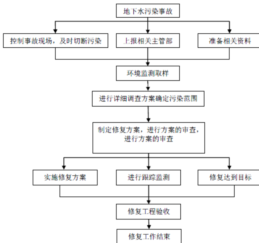
图 8.2.3-2 地下水污染应急治理程序图
