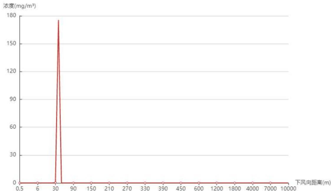
图 6.1.7-1 不利气象条件下丙烯储罐泄露事故下风向距离浓度曲线图
