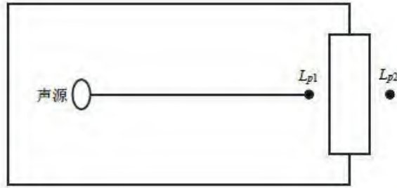
图 5.5-1 室内声源等效为室外声源图例
