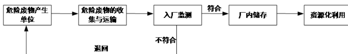
图 3.1-1 项目总体工艺流程示意图
