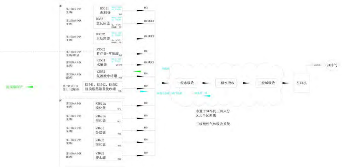
图 4.5.1-1 酸性气回收系统工艺流程及产污环节图
