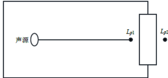
图 6.5.2-1 室内声源等效为室外声源图例
