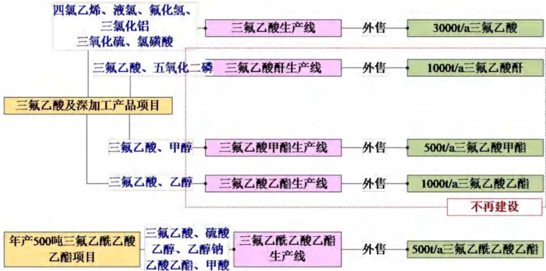
图 2.3-2 西厂区现有总体工艺路线图
