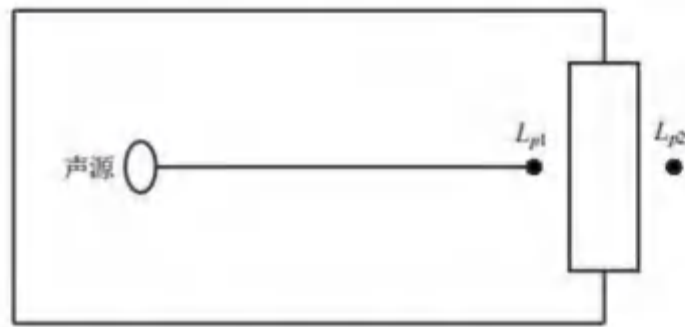
图 7.5-1 室内声源等效为室外声源图例
