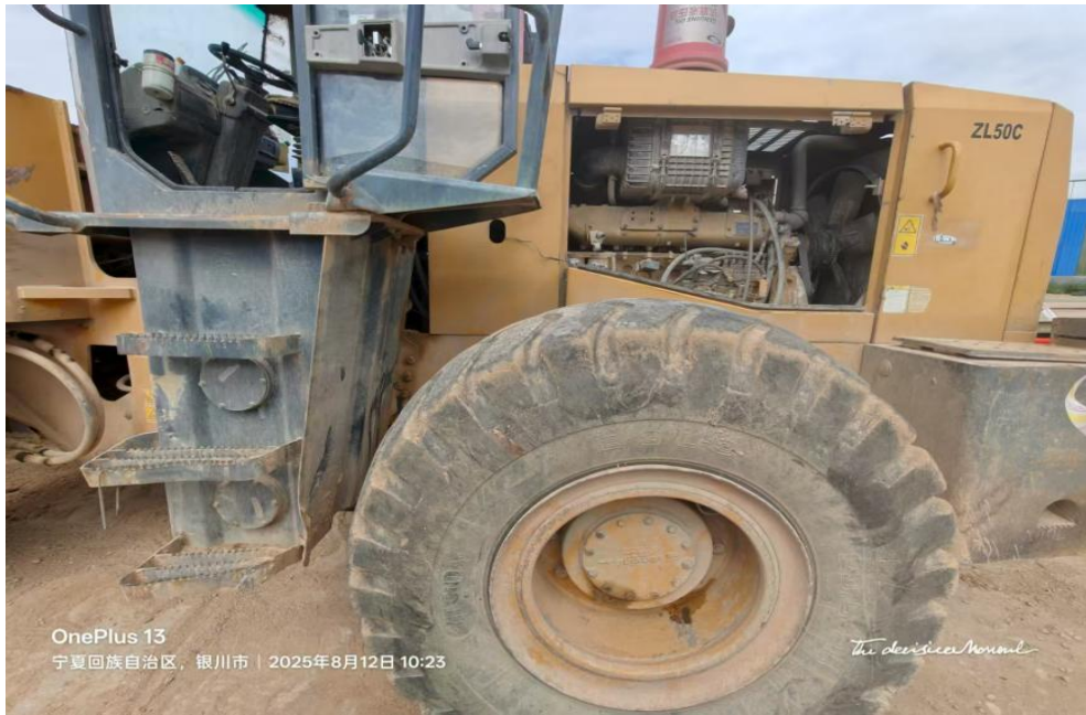
图 1 装载机发动机盖敞开，左后轮挡内壁可见摩擦痕迹
