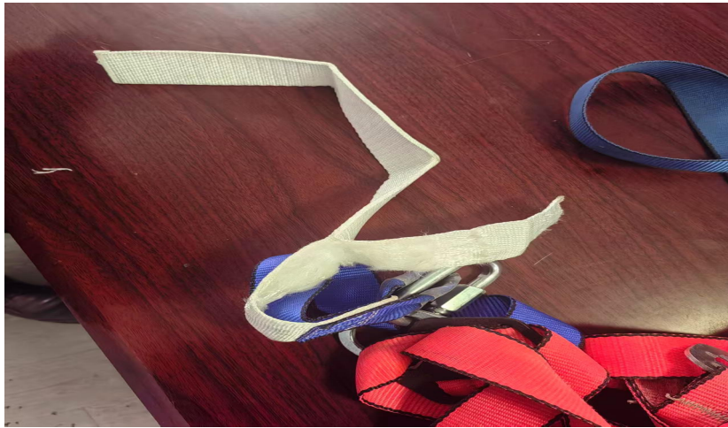
图七安全带断裂位置图
