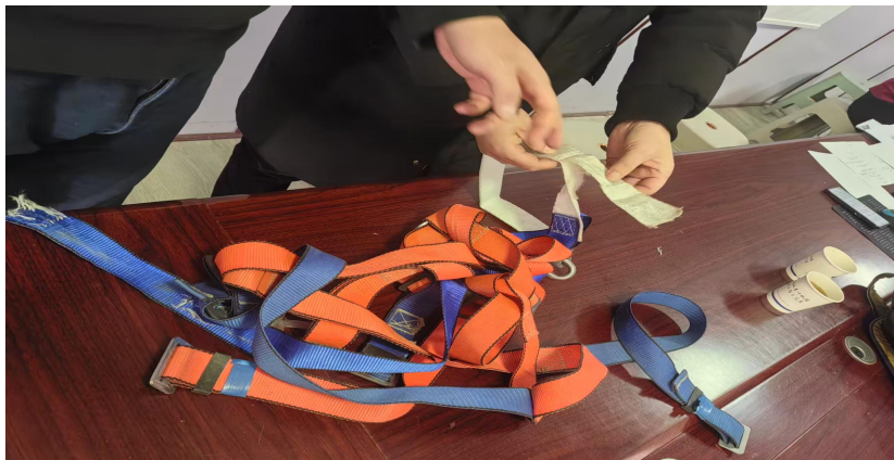
图六 死者佩戴安全带掉落部分图
