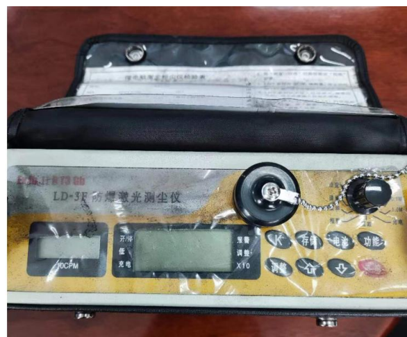
图 2.3-27 梅花井洗煤厂配备的噪声、粉尘检测仪
