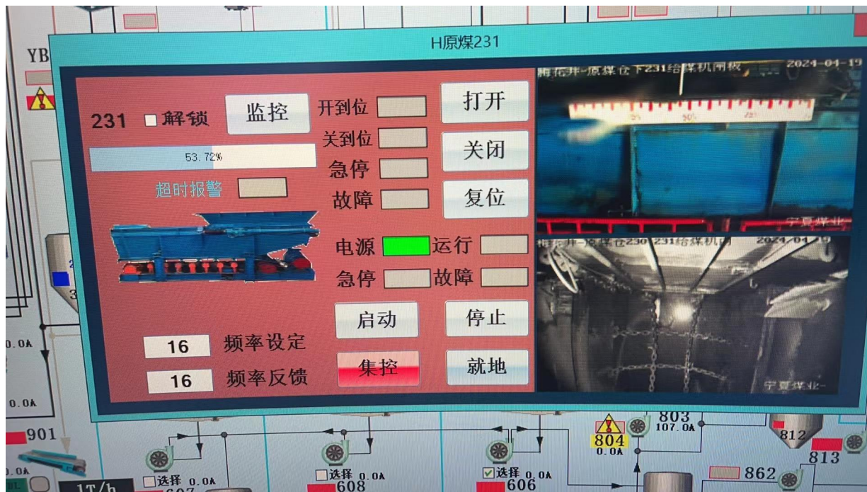
图 2.3-8 原煤仓下供料系统可视化自动控制
