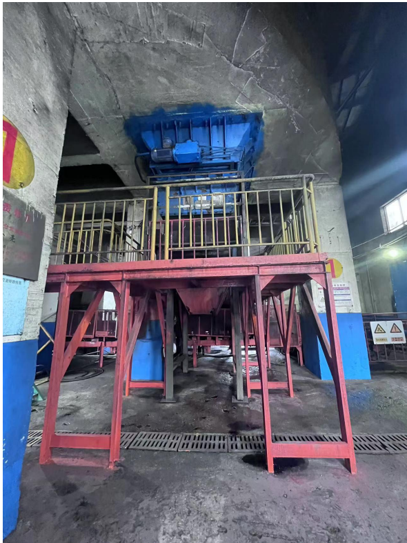
图 2.3-41 梅花井洗煤厂给煤机进行了加固（刷灰色油漆为加固措施）
