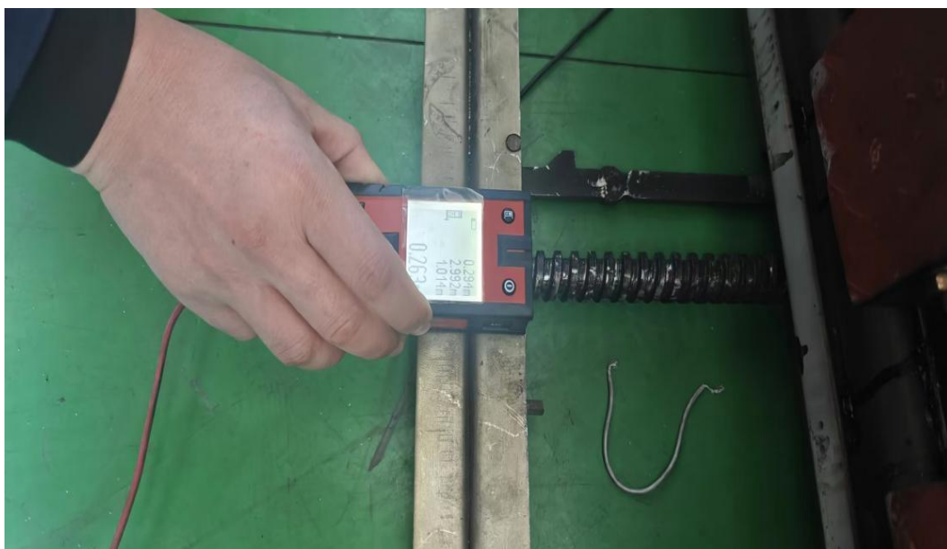
图 3 手车螺杆向外伸出 0.263m
